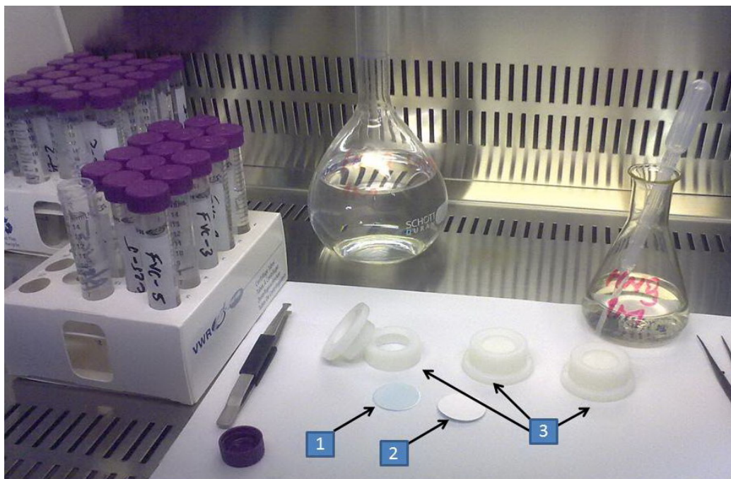
Figura 1. Componentele dispozitivului DGT (1- disc de difuzie; 2-disc de fixare; 3- dispozitive DGT).
